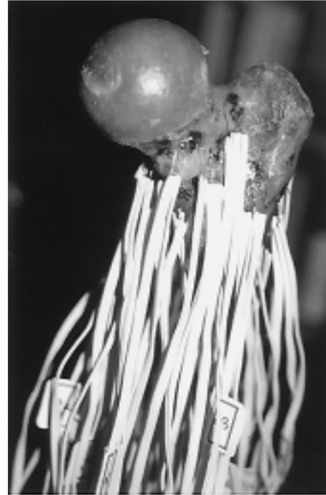
Fig. 6 大腿骨表面センサー張り付け
