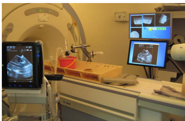
図 9 通常 MR 装置と超音波画像装置を併用する標的追尾ロボット。
