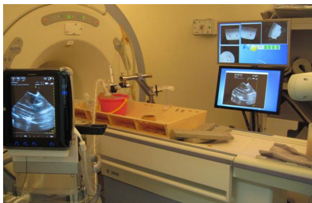
図 9 通常 MR 装置と超音波画像装置を併用する標的追尾ロボット。
