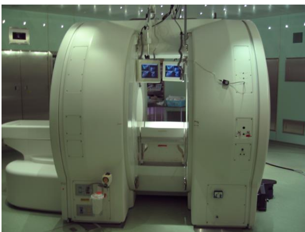
図5 ダブルドーナツ型オープンMR装置SIGNA SPi. 2つのマグネットが縦方向に並び術者はその間からMR画像をモニターしながら手術を行う。
