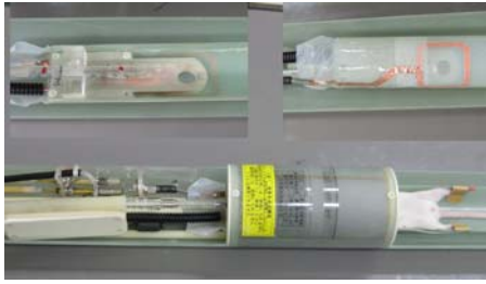
図2 HMQCのための ^1\text{H} - ^{13}\text{C} 二重同調検出コイル。T/R制御可能な ^1\text{H} 用外径60mmの送信用容積コイル(図下)、直径15mmの受信用表面コイル(図左上)を導入し、これに自作の ^{13}\text{C} 表面コイル(図右上)を組み合わせて、マウス脳用RFコイルを製作した。
