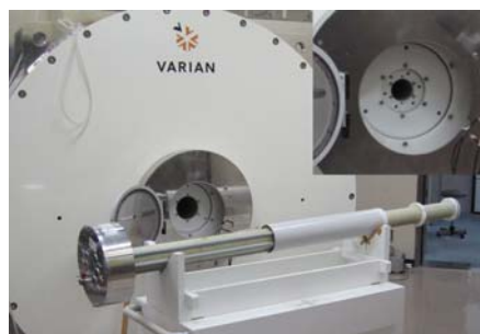
図 1 7T MR 装置と傾斜磁場コイル。3 種類の内径の傾斜磁場コイルを選択できる (右上)
