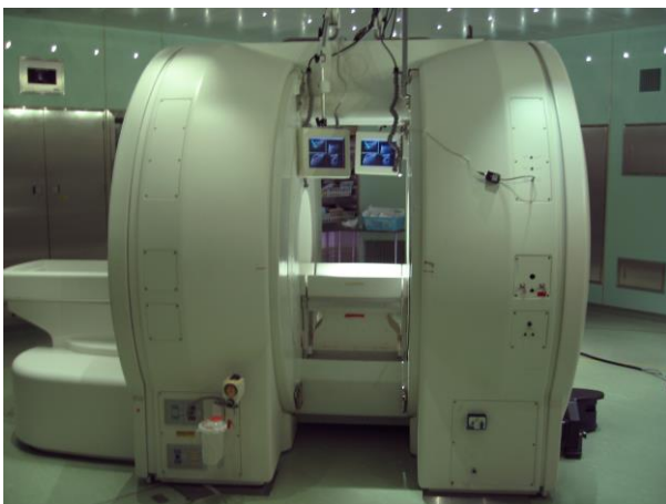
図5 ダブルドーナツ型オープンMR装置SIGNA SPi. 2つのマグネットが縦方向に並び術者はその間からMR画像をモニターしながら手術を行う。
